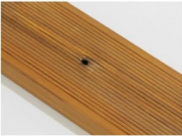
На доске допускается маленькое отверстие от сучка (не сквозное)
