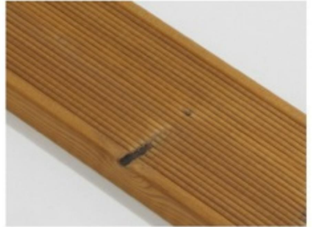
Пропущенный сучек не большого размера может быть допустим
