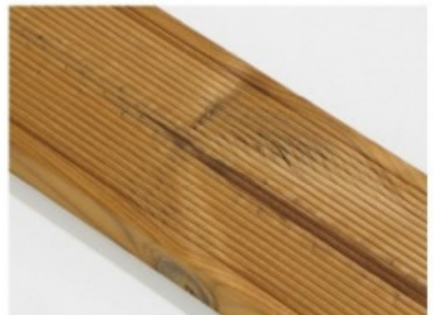
Маленькие трещины на лицевой поверхности допустимы
